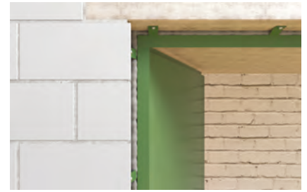
Door Gap filling
